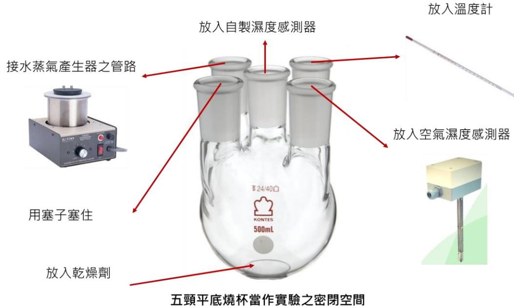
利用水蒸氣產生器+空氣濕度感測器+乾燥劑，調節密閉空間之濕度值，經由分壓電路傳回示波器，擷取其訊號。
